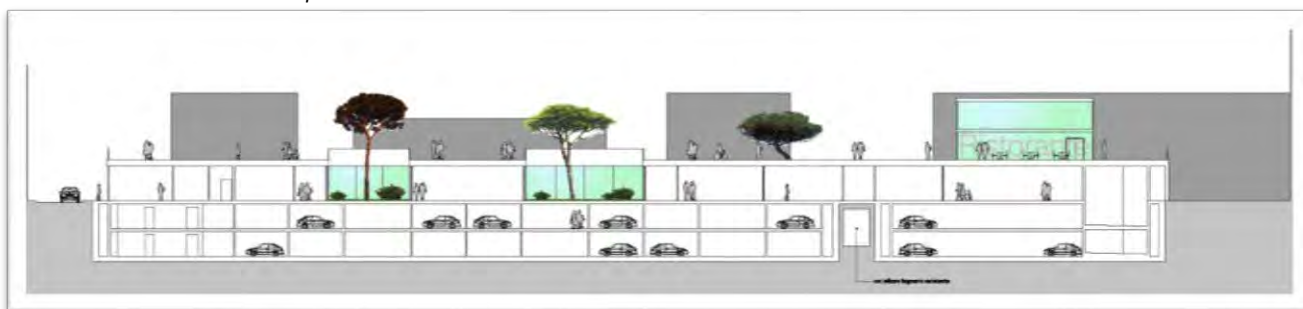
Sezione parcheggio interrato
